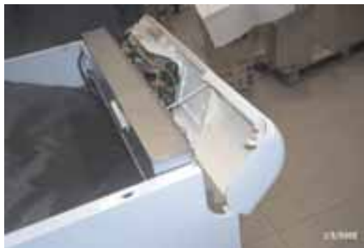
Рис. 6 - Поверните панель управления вперед.
