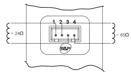
рис. 11 - Электрический разъем для подключения газового клапана
