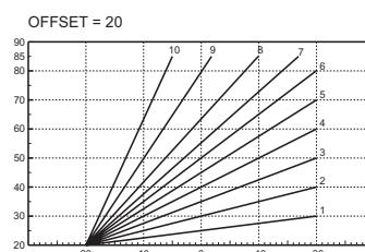
рис. 6 - Пример параллельного смещения компенсационных характеристик
