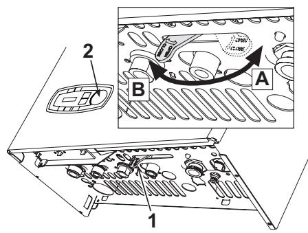
рис. 7 - Кран для заливки воды
