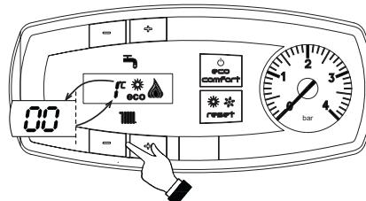
рис. 9 - Режим TEST (мощность системы отопления = 100%)
