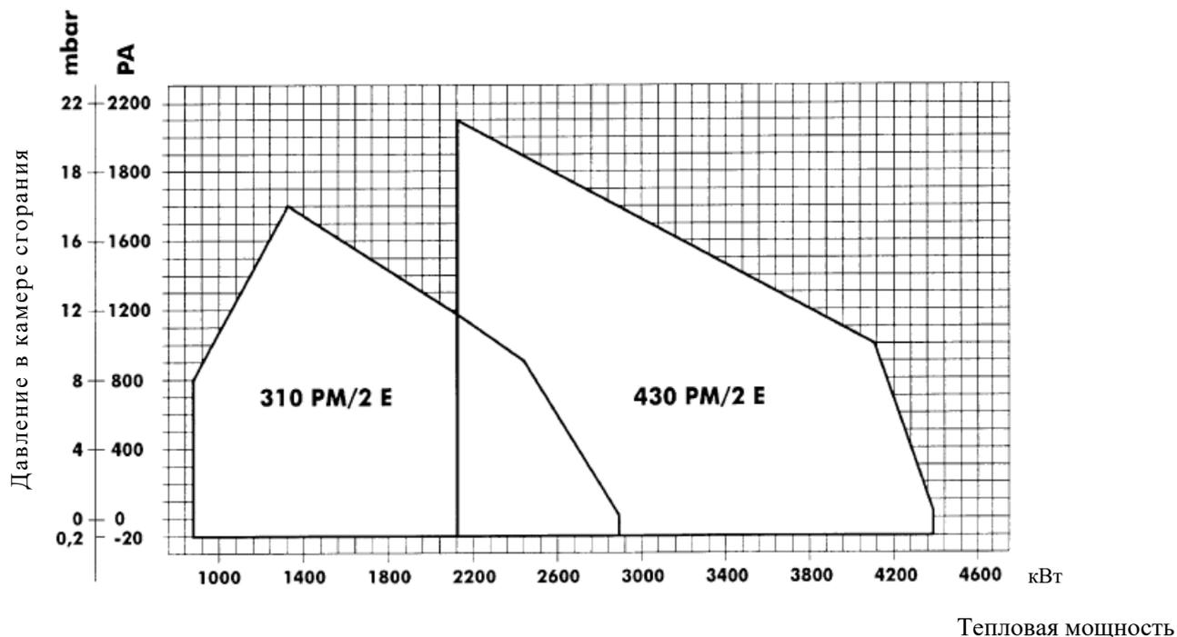
Рабочие кривые показывают тепловую мощность в кВт в зависимости от противодействия (в мбар или Па) в камере сгорания.
