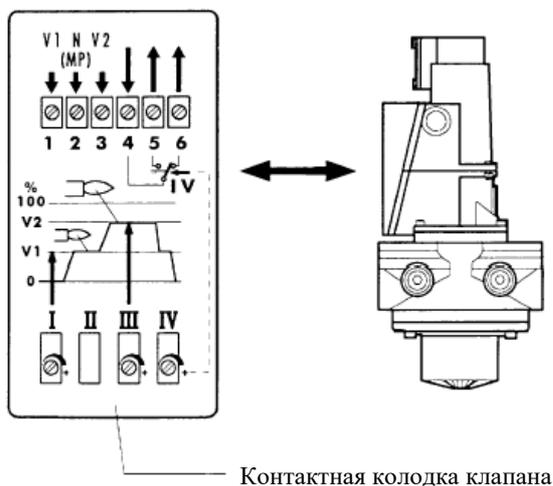
Клапан приводится в действие электродвигателем и имеет два открытых положения, установка в которые производится с электрического пульта управления. Если подключен ТМФ (терморегулятор модулирования пламени), то закрытие проходит в два этапа. Регулировка осуществляется специальными винтами внутри контактной колодки согласно инструкциям.
