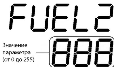
Нажатием кнопки  $\bar{i}$  выполняется переход к режиму ИЗМЕНЕНИЕ ЗНАЧЕНИИ ПАРАМЕТРА, при котором значение отображаемого параметра мигает.
