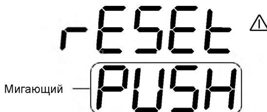
Последующее на тие кнопки R вызывает разблокирование аппаратуры и возвращение к нормальному ре иму отобра ения.
