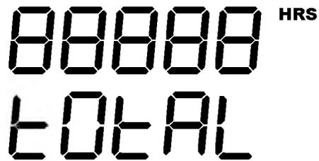
Для обнуления всех соответствующих работе горелки счетчиков, необходимо нажать кнопку и во время следующего отображения:
