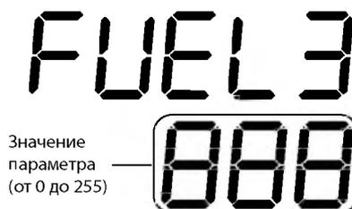
Нажатием кнопки  $\bar{i}$  выполняется переход к режиму ИЗМЕНЕНИЕ ЗНАЧЕНИИ ПАРАМЕТРА, при котором значение отображаемого параметра мигает.
