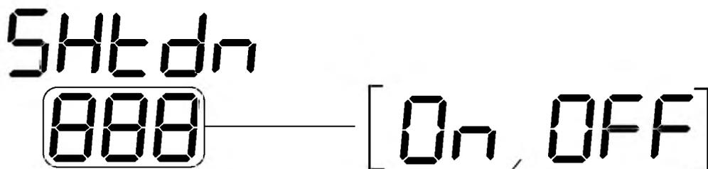
Нажатием кнопки  $\bar{i}$  выполняется переход к режиму ИЗМЕНЕНИЕ ЗНАЧЕНИИ ПАРАМЕТРА, при котором значение отображаемого параметра мигает.
