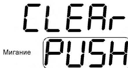
Последующее нажатие кнопки **i** во время этого отображения устанавливает обнуление всех счетчиков, соответствующих расходам топлива, и возвращает отображение расхода топлива первой ступени.
