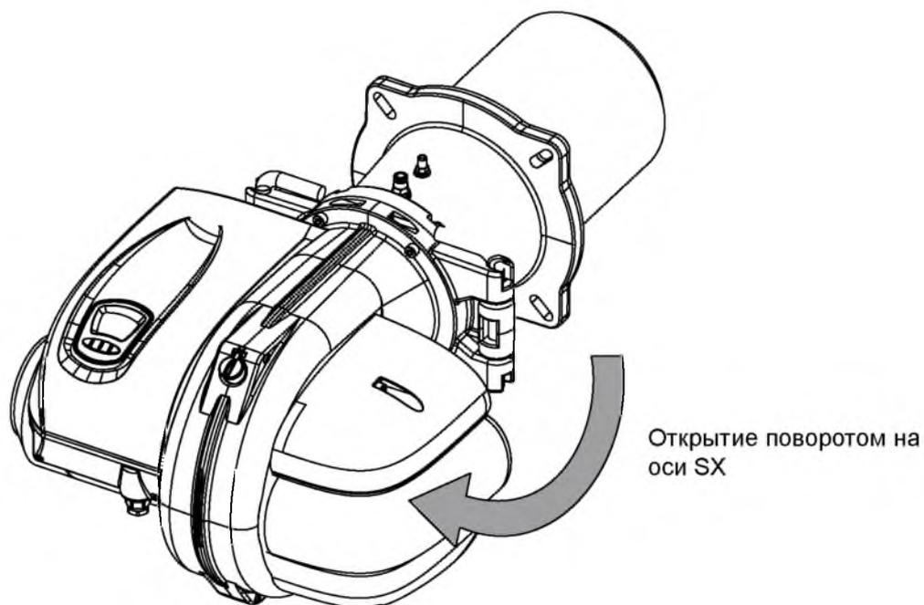
Для информации по регулировке воздушного кольца см. параграф РЕГУЛИРОВКИ
